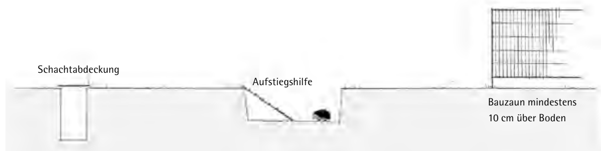
Abb. 4: Vermeiden von Tierfallen bei der Planung der Baustelleneinrichtung.
